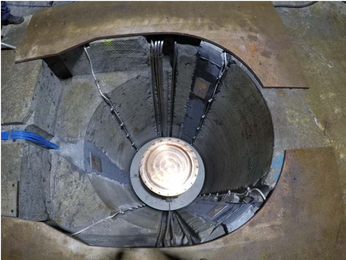
Kuva 4-7. Kapseli on asennettu instrumentoituun koeloppusijoitusreikään.
