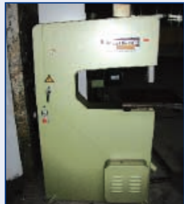
Bandzaag/Bandsaw STARTRITE, type 24-T-10, zaagbreedte: 600 mm, tafel: 480 mm x 480 mm.
