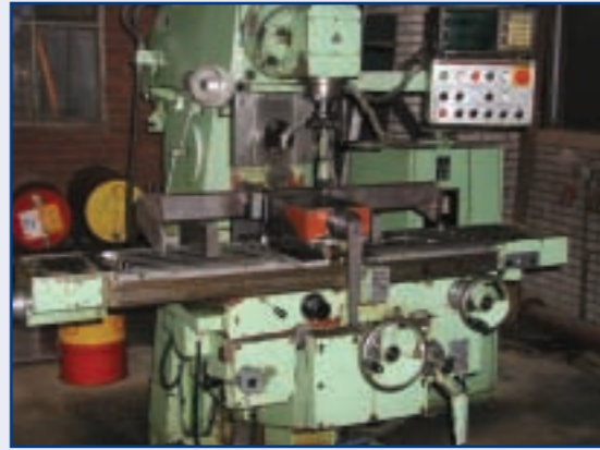
Freesbank/Milling Machine TOS, type FGE 32, X-as = 850 mm, Y-as = 300 mm, Z-as = 420 mm, horizontaal-verticaal kop 360° zwenkbaar, met losse draaitafel, tafel afm. 320 x 1.250 mm.
