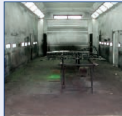
6 st. Straal-spuitskabines/6 off Shotblasts ROWIT STRAALTECHNIEK, lengte: ca. 18 m, breedte: ca. 6 m, hoogte: ca. 5 m, + luchtbehandelingsinstallatie
