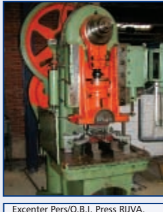
Excenter Pers/O.B.I. Press RIJVA, type 509, slag 20-120 verstelbaar, aantal slagen: 60, steekverst. 70 mm, snijcap. 3.125 mm, cap 125 ton.
