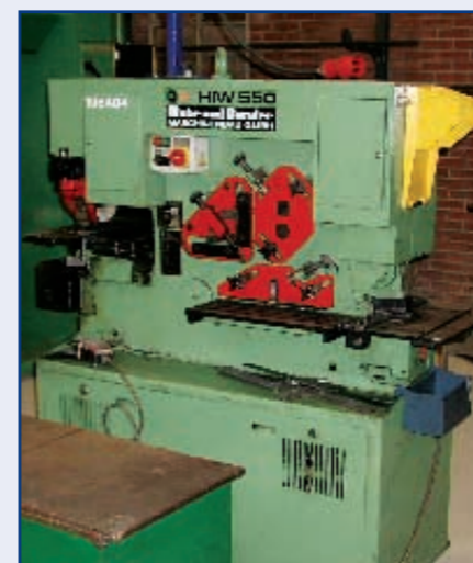
Gecombineerde pons-/knipmachine MUHR UND BENDER, type HIW 550, materiaaldikt 4-24 mm.
