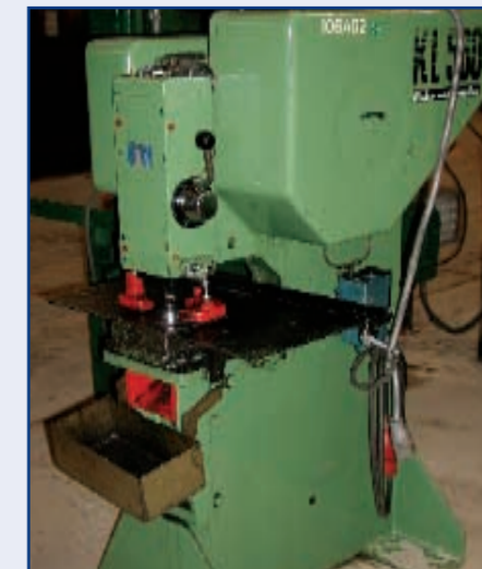
Ponsmachine/Punch MUHR UND BENDER, type KL 560, materiaaldikte 15 mm ø 30.
