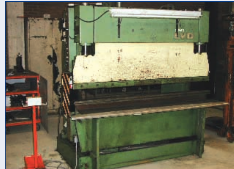
Kantbank/Hydr. Pressbrake LVD, type PP, cap. 30 ton x 2.000 mm, max. slag 100 mm.
