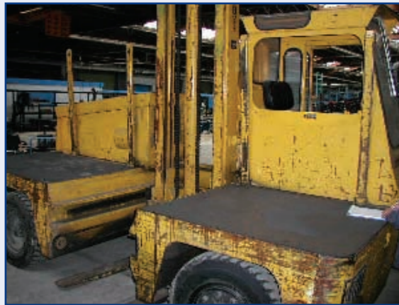
Zijlader/Sideload LANCER BOSS, 3 ton, met 2 palletplateaus.
