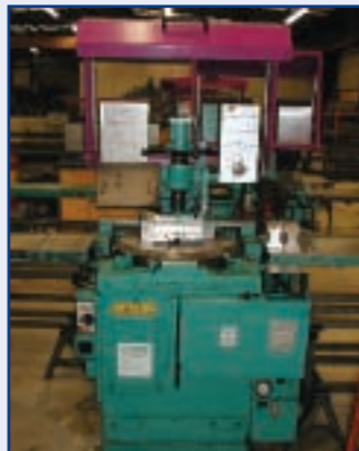
6 st. Zaagmachines/6 off Circular Saws KALTENBACH, type HKS 400, met materiaalafzels.
