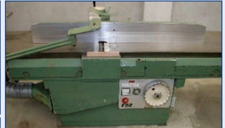
Vlankbank/Surfaceplaner SCM, type F52, werkbreedte 510 mm, tafellengte 3.000 mm.
