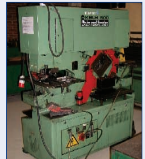
Gecombineerde pons-/knipmachine/ironworker MUHR UND BENDER, type KBL 500, materiaaldikte 4-24 mm.
