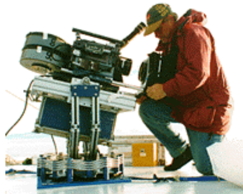
(IMAX 3D Kamera mit zwei separaten Objektiven und Filmtrommeln)
