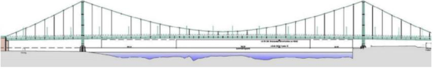
Instandsetzung und Verstärkung sowie Erneuerung der Hängerseile und des Korrosionsschutzes
